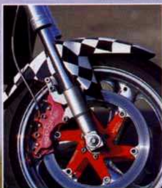
FZR-YZF přední vidlice, přední kolo FZR 1000 a příšerně drahá, ale velice účinná šestipístová Beringer brzda nevypadají právě nejhůř.
